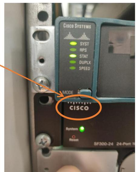
En appuyant sur le bouton «Mode», cela interrompt le processus de démarrage avant que le système de fichiers Flash peut initialiser
